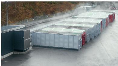
Axpo Tegra hat sich mit der installierten Containertrocknung und der grossen Bandtrocknungsanlage eine hohe Kompetenz im Bereich der Trocknung von verschiedenen Stoffen erarbeitet. Dabei bildet die Holztrocknung den Schwerpunkt - sei es von Schnitzeln für Holzfeuerungen in unterschiedlichen Korngrössen oder von Scheitholz für Cheminéefeuerungen.
